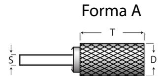
Cilíndrica sin corte frontal
