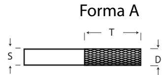
Cilíndrica sin corte frontal
